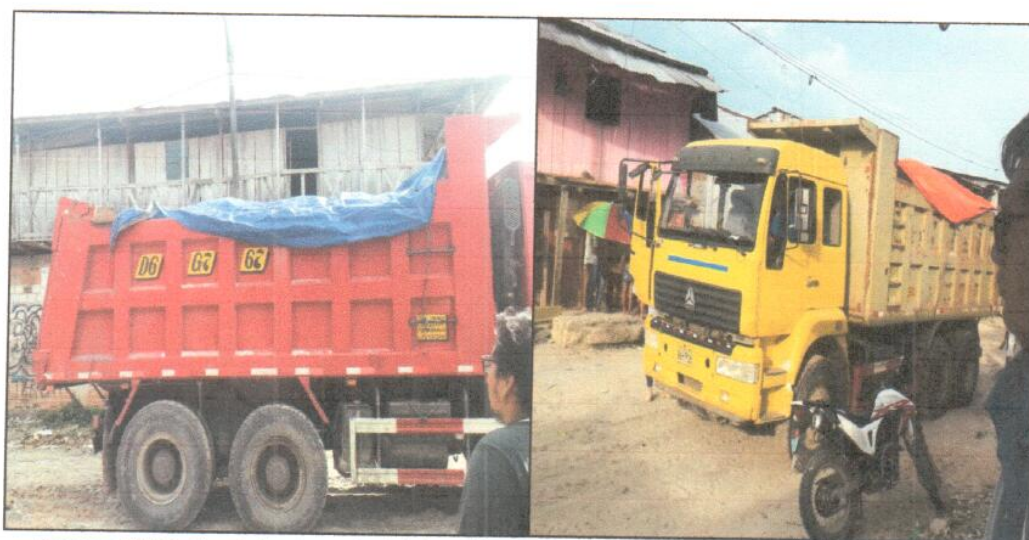
Imagen N°12: Traslado de material de relleno tipo A-3, los vehículos transitan por las vías con el respectivo recubrimiento del material trasladado a fin de evitar que las partículas de material se disperse en las calles de la ciudad.
